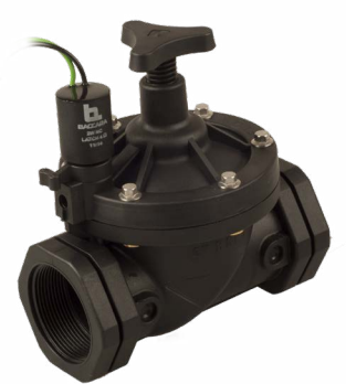
G75-Z | Diferenciales de Presión Cero Eléctricas e Hidráulicas Cuerpo de Plástico | 3/4" - 2" 2 Vías NC, NO
