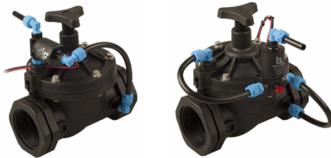
G75-S | Hidráulicas de 3 vías piloteadas con solenoide | 3 /4" - 4" NC, NO
